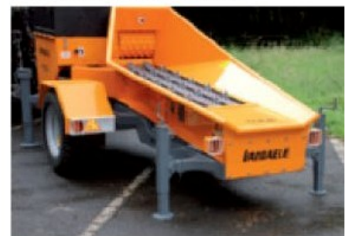
Option Kraneinfuhr – Ausführung mit verlängertem Trichter; Ketten- und Räder-Fahrgestell für den langsamen Transport.
