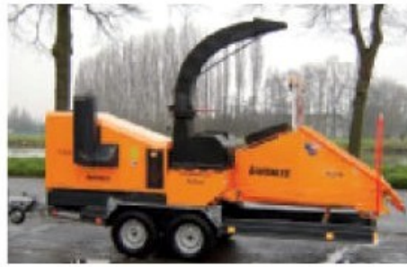
Mit Motorantrieb zum Schnelltransport – schwere Ausführung mit 135-PS-Deutzmotor.
