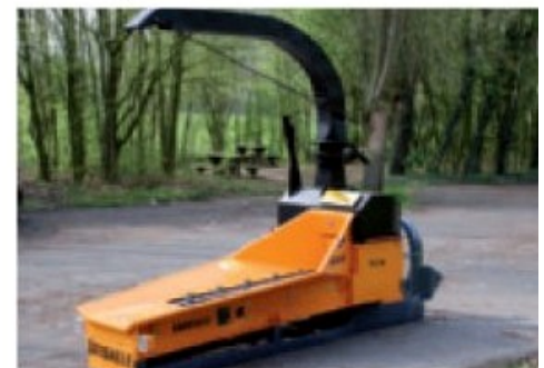
Option Kraneinfuhr – Ausführung mit speziell verlängertem Trichter mit Kette.
