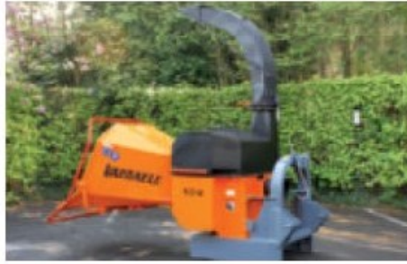
Maschine mit standardmäßiger 3-Punkt-Aufhängung
