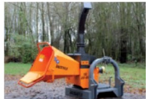
TV20-26 P; mit Schlepperantrieb, um 2 x 90° schwenkbar (Option)
