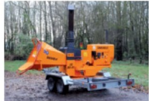
TV20-26 D; Fahrgestell auf Tandemachse, um 360° schwenkbar (Standardausführung)
