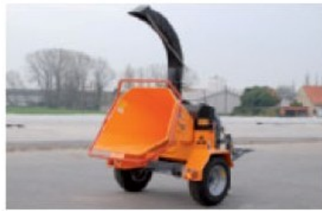
TV20-26 P; mit Schlepperantrieb, Räderfahrwerk für den langsamen Transport (Option)
