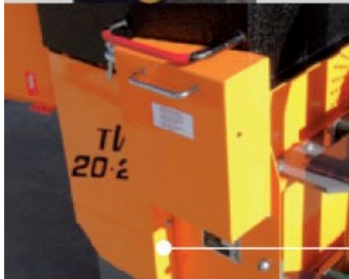
Elektrische Verriegelung der oberen Abdeckung (Option)
